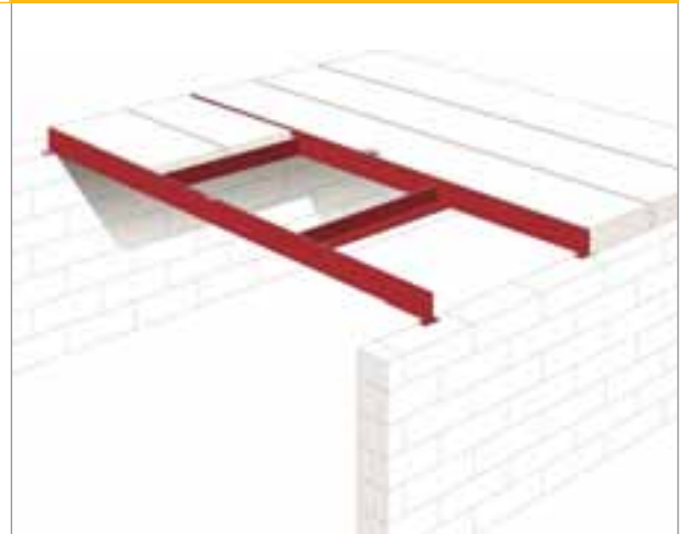
2 Cavedio nel solaio YTONG: larghezza di 2 lastre
